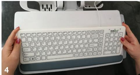
Positionnez au mieux le clavier et sa plaque métallique sur la tablette, appuyez légèrement sur le clavier pour que l'adhésif adhère.
