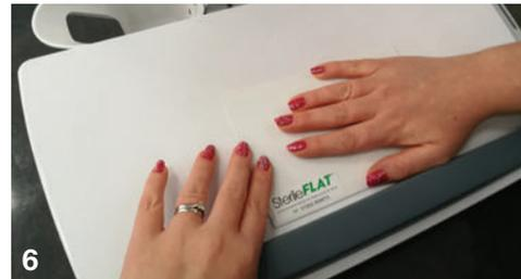
Appuyez bien sur la plaque de fixation pour finir de bien coller la plaque métallique à la tablette. Vous pouvez repositionner le clavier magnétique SterileFLAT.
