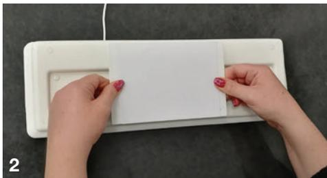
Positionnez la plaque de fixation sur la base magnétique du clavier. Assurez-vous que celle-ci soit bien en contact avec les aimants.
